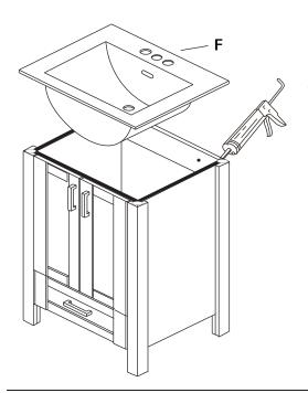
NOTE: Il est conseillé d'ajouter un filet de silicone sur le pourtour du dessus du cabinet. Puis déposez l'évier avec précaution sur le dessus et essuyez immédiatement toute trace visible de silicone. Le silicone n'est pas inclus.
